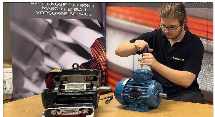
Thomas Stech beim zerlegen eines Drehstromasynchron-motors.
